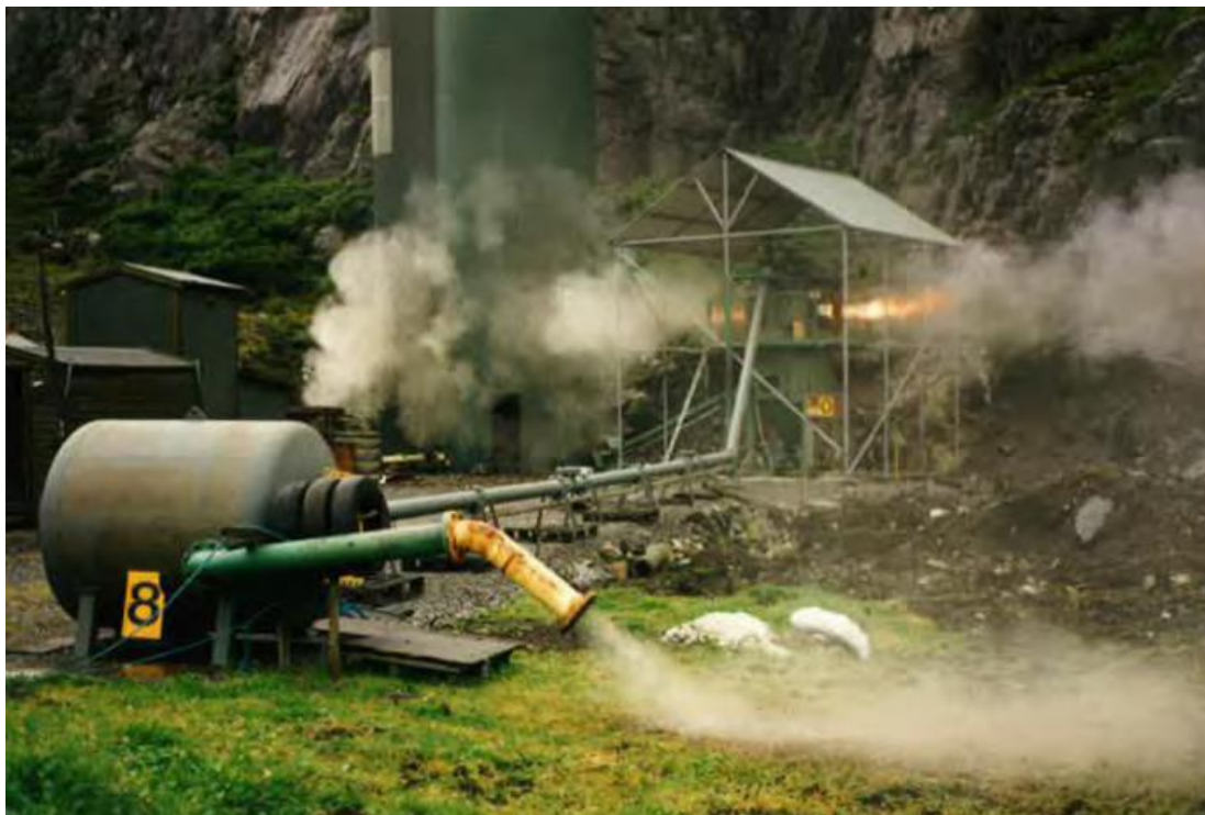
Figur 26. Försökupställning med slangfilter, 22 m kanal och ett mottagande käril.
